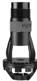
**ZM®II喷嘴：**闭式冷却塔对喷淋水的要求与冷却塔有所不同，部分闭式冷却塔采用ZM®II喷嘴，喷嘴靠螺纹拧在PVC水分配管上合适的位置，大口径的孔口可防止堵塞。
