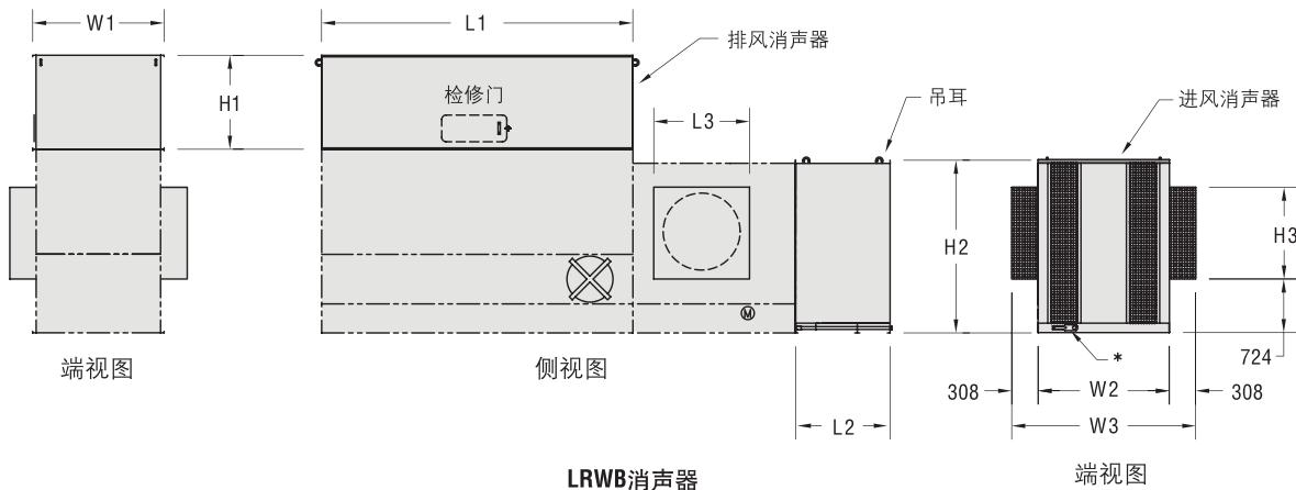
注意：进风消声器必须被完全支撑。如采用推荐的钢支撑，应有第三条工字钢来支撑进风消声器。详见第37页。
