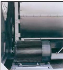
LRWB闭式冷却塔的另一个特点是通风机部分的外壳可以拆卸，以便快速地将通风机从机组前端拆下。当几台机组并排放置而且空间又比较小时，可以采取这种做法。
